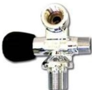
Zawór pojedynczy doczołowy Prawy DIN do rozbudowy (lub do manifoldu doczołowego) nr katal. 10134 gwint do butli M25X2
