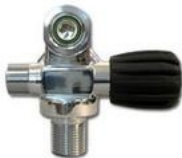
Zawór pojedynczy Prawy DIN/INT do rozbudowy (lub do manifoldu doczołowego) nr katal. 10071 gwint do butli M25X2 (na zamówienie 3/4" lub 17E)
