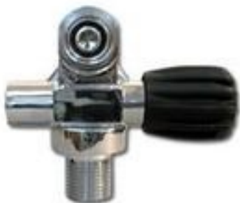
Zawor pojedynczy centryczny DIN/INT Prawy nr katal. 10148 – do manifolds (możliwy montaż rozbudowy – na zamówienie). Gwint do butli M25X2 (na zamówienie 3/4" lub 17E)
