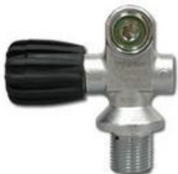
Zawór pojedynczy Lewy DIN/INT 232 bar nr katal. 10064 gwint do butli M25X2 (na zamówienie 3/4" lub 17E)
